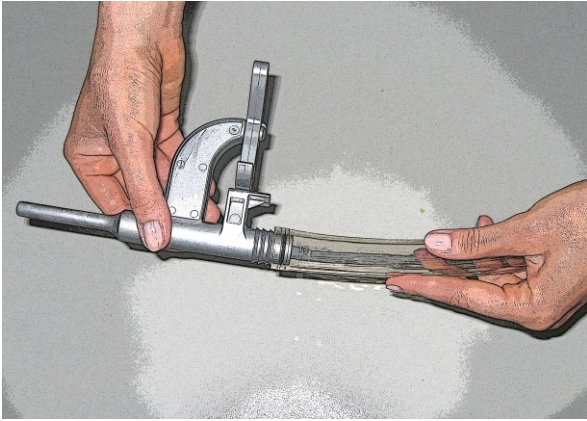
Ladevorrichtung und Ladeschlauch aufeinander stecken.
